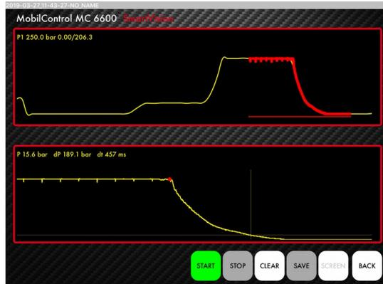
Die Kanäle P1 bis P3 können bis zu eine Minute lang mit 1000 Messungen pro Sekunde aufzeichnen. Um in den so genannten Fast-Mode zu gelangen, tippen Sie in der 6-Kanal-Darstellung in den Digitalwert-Bereich des jeweiligen Kanals.
